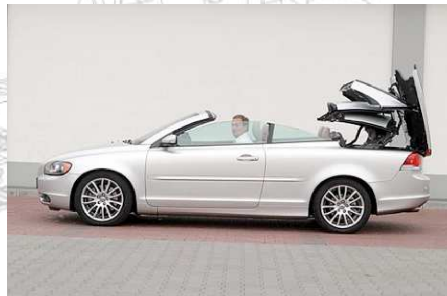
Składany dach (Cabrio-Coupé) dla Webasto dla Volvo C70 – główne ramię składanego dachu
